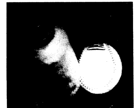
Figura 1 Fotografía a alta velocidad de un bate al chocar contra una bola de béisbol. Nótese la deformación de la bola, que indica la gran fuerza impulsiva ejercida por el bate.
